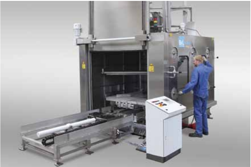
Variante: OceanRW mit hydraulischem Einschub, Spezialdüsenrahmen, Handlanzen und Sichtfenster; als Ausführung für Zentraltank-System
